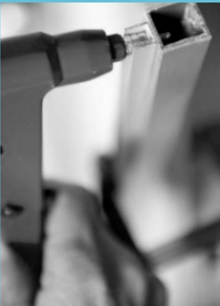
Los remaches son fijaciones especializadas que a diferencia de los tornillos, hacen uniones fijas. Cuando unimos dos piezas con un remache, este quedará fijo y solo se podrá retirar “rompiendo” la unión.
