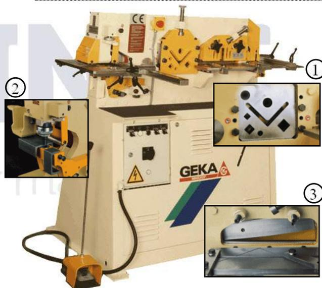
1. Sistema patentado de corte en L a 90º sin deformación.
