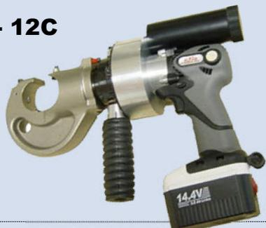
**AHB-12C**, herramienta de compresión hidráulica accionada con un motor a batería para terminales y manguitos de baja tensión. Terminal de cobre tubular max. 400mm<sup>2</sup> y 300mm<sup>2</sup> en Aluminio. Fuerza de crimpado 120 Kn, presión de trabajo a 700 Bar y autonomía 91 crimpados.
