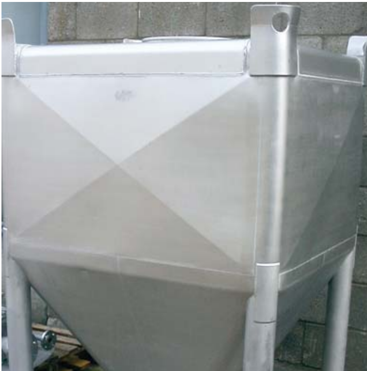
La acción combinada de limpieza, decapado y pasivado produce una superficie uniforme.
