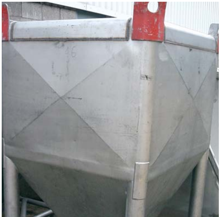
Efecto del tratamiento de superficie en un recipiente de acero inoxidable: antes del tratamiento, el recipiente muestra suciedad y rasguños debidos a la manipulación y rastros de pintura.
