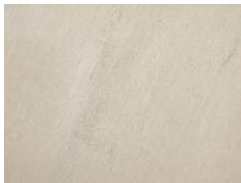
Superficie descascarillada, recocida y decapada: la cascarilla de óxido se elimina por medios mecánicos (desincrustación, granallado, cepillado) que dejan la superficie áspera. A continuación ésta se decapa y pasiviza. El resultado tiene un aspecto gris mate.
