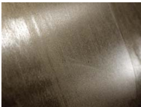
Superficie de acero inoxidable laminado en caliente antes del descascarillado: el color gris oscuro es consecuencia de las altas temperaturas a las que se realiza el proceso de laminación en caliente. Estas temperaturas inevitablemente producen una cascarilla de óxido de este tipo.
