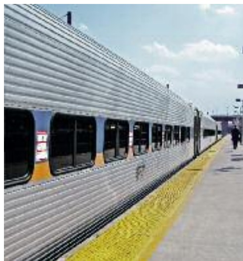
Figura 26: Los vagones de trenes con paneles exteriores en acero inoxidable austenítico se han utilizado en muchos lugares del mundo, sin problemas de corrosión galvánica.
